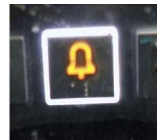
Foto - Botão de acionamento do alarme na cabina (destaque).
